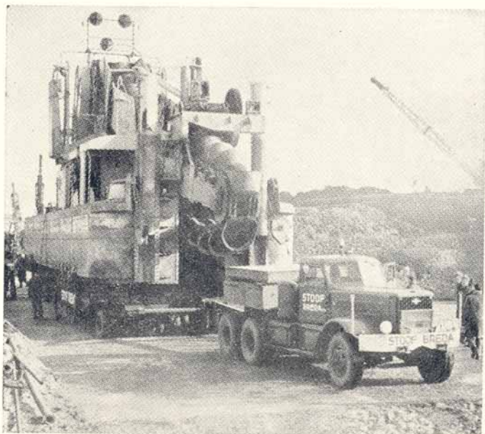
Transport van een 240 tons zandzuiger, hiervoor werd de 5e combinatie van pagina 30 gebruikt.
